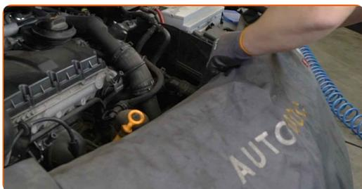
3 Κάντε στο πλάι την τροχαλία του τεντωτήρα του ιμάντα poly-V. Χρησιμοποιήστε ένα γερμανοπολύγωνο #16.
