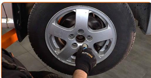
**16** Χαμηλώστε το αυτοκίνητο και χρησιμοποιήστε σταυρό, προκειμένου να σφίξετε τα μπουλόνια των τροχών. Χρησιμοποιήστε κρουστικό καρυδάκι για μπουλονόκλειδο Νο #17. Χρησιμοποιήστε ένα δυναμόκλειδο. Σφίξτε τη με ροπή 120 Nm.
