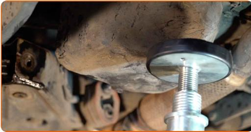
**19** Τοποθετήστε το εμπρόσθιο στοιχείο στερέωσης του ψαλιδιού.
