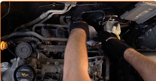
5 Αφαιρέστε τα πλαστικά κλιπ ασφαλείας από το σύνδεσμο του πολλαπλασιαστή. Χρησιμοποιήστε ένα ίσιο κατσαβίδι.
