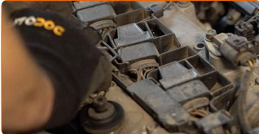
6 Σηκώστε τον πολλαπλασιαστή. Χρησιμοποιήστε ένα λοστό (2 τεμάχια).
