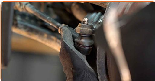
**15** Βιδώστε το μπαλάκι του ακρόμπαρου και το παξιμάδι ασφαλείας του ακρόμπαρου. Χρησιμοποιήστε ένα γερμανοπολύγωνο #19. Χρησιμοποιήστε ένα γερμανοπολύγωνο #22.
