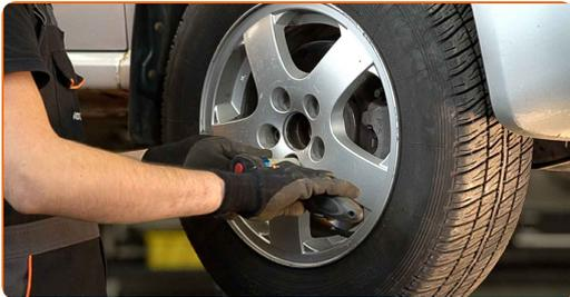
**23** Χαμηλώστε το αυτοκίνητο και χρησιμοποιήστε σταυρό, προκειμένου να σφίξετε τα μπουλόνια των τροχών. Χρησιμοποιήστε ένα δυναμόκλειδο. Σφίξτε τη με ροπή 120 Nm.
