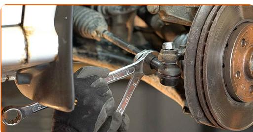
**16** Σφίξτε το παξιμάδι στερέωσης που συνδέει το μπαλάκι του ακρόμπαρου με το μουαγιέ. Χρησιμοποιήστε ένα καρυδάκι #19. Χρησιμοποιήστε ένα δυναμόκλειδο. Σφίξτε τη με ροπή 20 Nm.+90°
