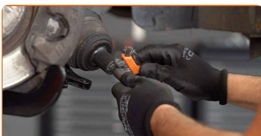
**42** Επεξεργαστείτε τη βάση του γόνατου του αμορτισέρ, επάνω στο μουαγιέ. Χρησιμοποιήστε σπρέι WD-40.
