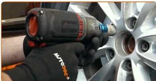
**21** Χαμηλώστε το αυτοκίνητο και χρησιμοποιήστε σταυρό, προκειμένου να σφίξτε τα μπουλόνια των τροχών. Χρησιμοποιήστε κρουστικό καρυδάκι για μπουλονόκλειδο No #17. Χρησιμοποιήστε ένα δυναμόκλειδο. Σφίξτε τη με ροπή 120 Nm.
