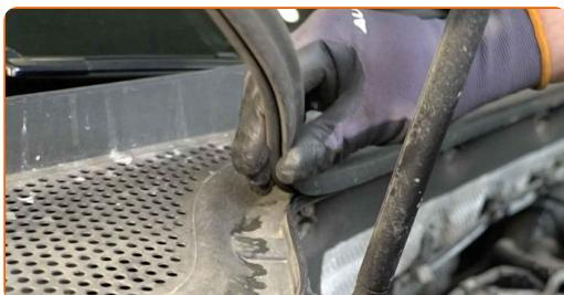
4 Αφαιρέστε τα κλιπ από το πλαστικό κάλυμμα του νεροχύτη. Χρησιμοποιήστε ένα λοστό.
