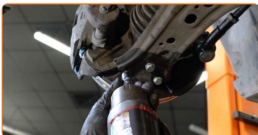
**18** Σφίξτε το μπουλόνι του μπαλακιού του ακρόμπαρου. Χρησιμοποιήστε ένα καρυδάκι #13. Χρησιμοποιήστε ένα δυναμόκλειδο. Σφίξτε τη με ροπή 20 Nm.+90°
