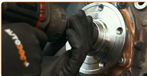
**56** Περάστε από επεξεργασία το τμήμα της πλήμνης του τροχού που έρχεται σε επαφή με το δίσκο του φρένου. Χρησιμοποιήστε γράσο χαλκού.
