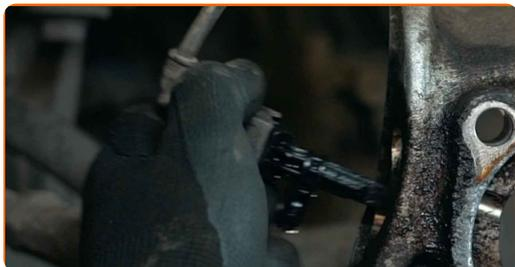
**40** Καθαρίστε το σημείο τοποθέτησης του ρουλεμάν της πλήμνης. Χρησιμοποιήστε μια συρματόβουρτσα. Χρησιμοποιήστε σπρέι WD-40.
