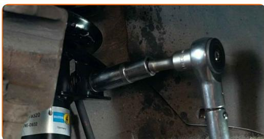
**55** Τοποθετήστε και σφίξτε τη βίδα του άξονα κίνησης. Χρησιμοποιήστε ένα καρυδάκι #27. Χρησιμοποιήστε μια καστανία.
