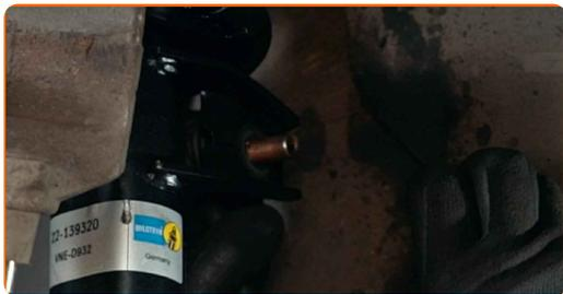
**54** Σφίξτε το στοιχείο στερέωσης που συνδέει το μπαράκι της αντιστρεπτικής στο γόνατο του αμορτισέρ. Χρησιμοποιήστε ένα γερμανοπολύγωνο #18. Χρησιμοποιήστε ένα καρυδάκι #18. Χρησιμοποιήστε ένα ΧΖΝ #6. Χρησιμοποιήστε ένα δυναμόκλειδο. Σφίξτε τη με ροπή 55 Nm.
