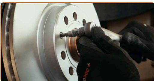
**59** Καθαρίστε τη βάση της δαγκάνας των φρένων από τη βρωμιά και τη σκόνη. Χρησιμοποιήστε μια συρματόβουρτσα. Χρησιμοποιήστε καθαριστικό φρένων.
