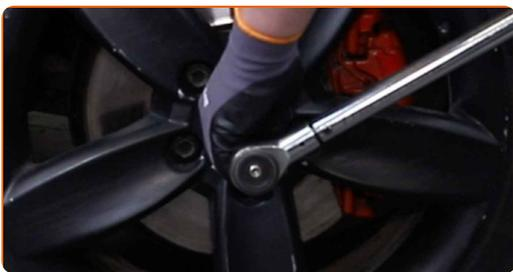
**86** Σφίξτε τα μπουλόνια του τροχού, σταυρωτά. Χρησιμοποιήστε κρουστικό καρυδάκι για μπουλονόκλειδο No #17. Χρησιμοποιήστε ένα δυναμόκλειδο. Σφίξτε τη με ροπή 120 Nm.
