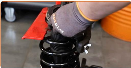
**49** Τοποθετήστε το άνω στήριγμα του γόνατου μαζί με το μπαμ στοπ.
