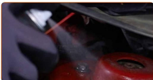
**8** Ξεσφίξτε τα επάνω στοιχεία στερέωσης του γόνατου ανάρτησης. Χρησιμοποιήστε ένα καρυδάκι #13. Χρησιμοποιήστε μια κασάνια.
