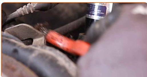
**75** Τοποθετήστε το στήριγμα του μαρκουτσιού φρένων.
