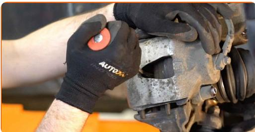
**11** Αφαιρέστε τη δαγκάνα του φρένου. Χρησιμοποιήστε ένα λοστό.
