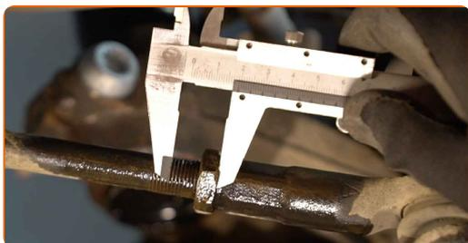
**7** Καθαρίστε το περικόχλιο ασφάλισης που συνδέει τη μπάρα διεύθυνσης με το ακρόμπαρο διεύθυνσης. Χρησιμοποιήστε μια συρματοβούρτσα. Χρησιμοποιήστε σπρέι WD-40.
