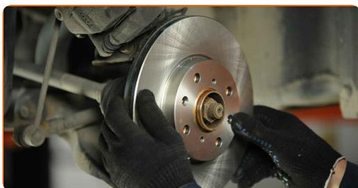
**21** Σφίξτε τις βίδες του δίσκου των φρένων. Χρησιμοποιήστε ένα Τορξ T30. Χρησιμοποιήστε ένα δυναμόκλειδο. Σφίξτε τη με ροπή 9 Nm.
