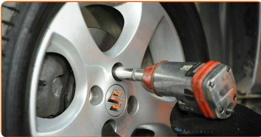
**40** Χαμηλώστε το αυτοκίνητο και χρησιμοποιήστε σταυρό, προκειμένου να σφίξετε τα μπουλόνια των τροχών. Χρησιμοποιήστε κρουστικό καρυδάκι για μπουλονόκλειδο No #21. Χρησιμοποιήστε ένα δυναμόκλειδο. Σφίξτε τη με ροπή 85 Nm.
