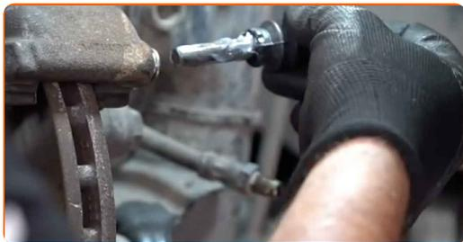
**27** Καθαρίστε τα στοιχεία στερέωσης της βάσης της δαγκάνας των φρένων. Χρησιμοποιήστε μια συρματόβουρτσα. Χρησιμοποιήστε σπρέι WD-40.
