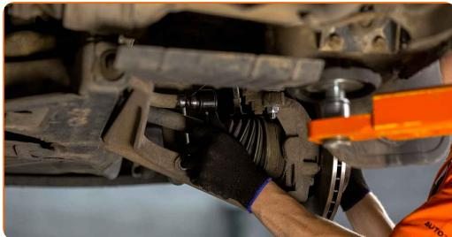
**13** Τοποθετήστε τη βίδα στερέωσης. Χρησιμοποιήστε ένα σφυρί.
