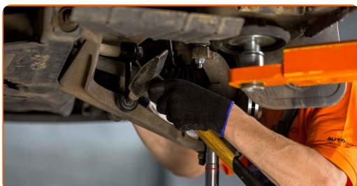
**14** Σφίξτε το στοιχείο στερέωσης που συνδέει το γόνατο του αμορτισέρ με το βραχίονα ελέγχου της ανάρτησης. Χρησιμοποιήστε ένα καρυδάκι #21. Χρησιμοποιήστε ένα δυναμόκλειδο. Σφίξτε τη με ροπή 160 Nm.
