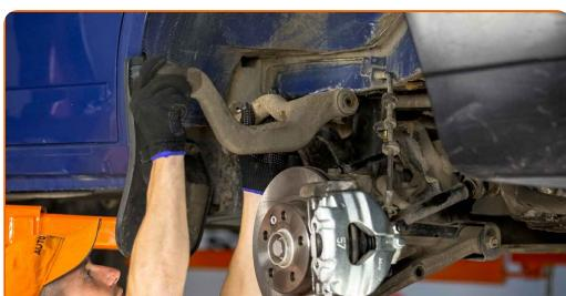
26 Καθαρίστε τις βάσεις τοποθέτησης και το σπείρωμα του ψαλιδιού της ανάρτησης. Χρησιμοποιήστε μια συρματόβουρτσα. Χρησιμοποιήστε σπρέι WD-40.
