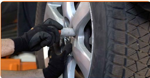
**29** Χαμηλώστε το αυτοκίνητο και χρησιμοποιήστε σταυρό, προκειμένου να σφίξετε τα μπουλόνια των τροχών. Χρησιμοποιήστε ένα δυναμόκλειδο. Σφίξτε τη με ροπή 103 Nm.
