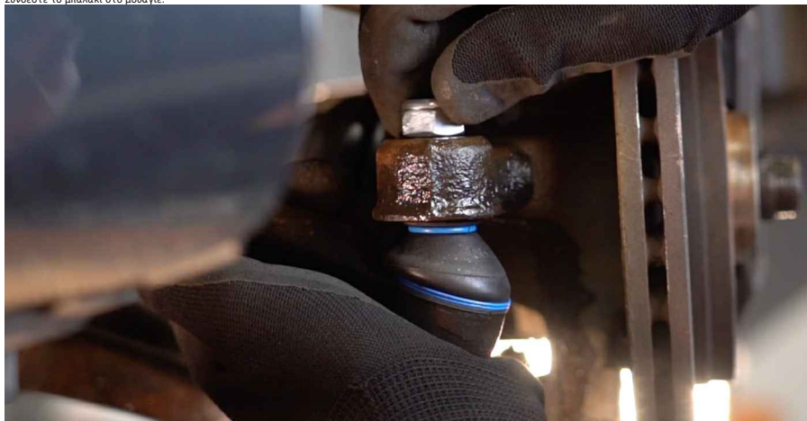
18 Σφίξτε το παξιμάδι στερέωσης που συνδέει το μπαλάκι του ακρόμαρου με το μοχλιέ. Χρησιμοποιήστε ένα καρουδάκι #17. Χρησιμοποιήστε ένα δυναμόκλειδο. Σφίξτε τη με ροπή 33 Nm.
