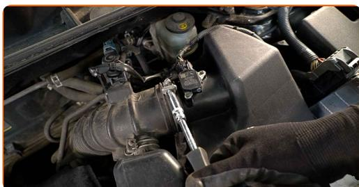
**7** Αποσυνδέστε τον σωλήνα εισαγωγής αέρα από το περίβλημα του φίλτρου αέρα.
