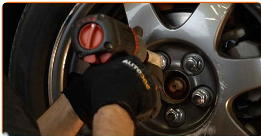
**19** Χαμηλώστε το αυτοκίνητο και χρησιμοποιήστε σταυρό, προκειμένου να σφίξετε τα μπουλόνια των τροχών. Χρησιμοποιήστε κρουστικό καρυδάκι για μπουλονόκλειδο No #21. Χρησιμοποιήστε ένα δυναμόκλειδο. Σφίξτε τη με ροπή 103 Nm.
