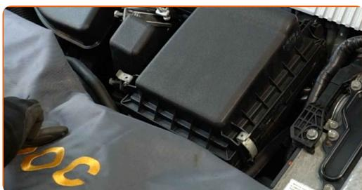
**13** Σφίξτε το κολάρο του σωλήνα εισαγωγής αέρα. Χρησιμοποιήστε ένα καρυδάκι #10. Χρησιμοποιήστε μια καστάνια.
