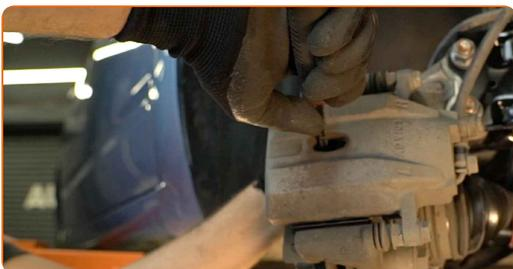
**8** Καθαρίστε τα στοιχεία στερέωσης της δαγκάνας των φρένων. Χρησιμοποιήστε μια συρματόβουρτσα. Χρησιμοποιήστε σπρέι WD-40.
