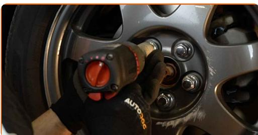
**22** Χαμηλώστε το αυτοκίνητο και χρησιμοποιήστε σταυρό, προκειμένου να σφίξετε τα μπουλόνια των τροχών. Χρησιμοποιήστε ένα δυναμόκλειδο. Σφίξτε τη με ροπή 103 Nm.
