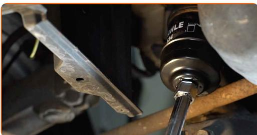
10 Ετοιμάστε ένα δοχείο για το παλιό φίλτρο λαδιού. Βάλτε το παλιό φίλτρο λαδιού στο δοχείο.
