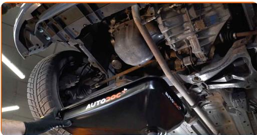
9 Ξεβιδώστε το φίλτρο λαδιού. Χρησιμοποιήστε ένα καρυδάκι 76/14-F.
