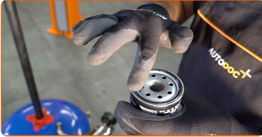
**13** Βιδώστε το φίλτρο στη θέση του. Χρησιμοποιήστε ένα καρυδάκι 76/14-F. Χρησιμοποιήστε ένα δυναμόκλειδο. Σφίξτε το με ροπή 23 Nm.
