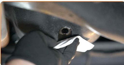
**15** Βιδώστε την καινούρια τάπα αποστράγγισης και σφίξτε τη. Χρησιμοποιήστε ένα καρυδάκι #15. Χρησιμοποιήστε ένα δυναμόκλειδο. Σφίξτε το με ροπή 27 Nm.
