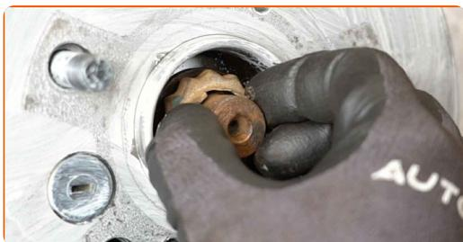
**58** Τοποθετήστε την κοπίλια. Χρησιμοποιήστε ένα λοστό.
