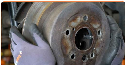
**23** Αφαιρέστε την αριστερή σούστα της σιαγόνας φρένου του χειρόφρενου. Χρησιμοποιήστε μωτοσίμπιδα μακριάς λαβής. Χρησιμοποιήστε ένα λοστό.
