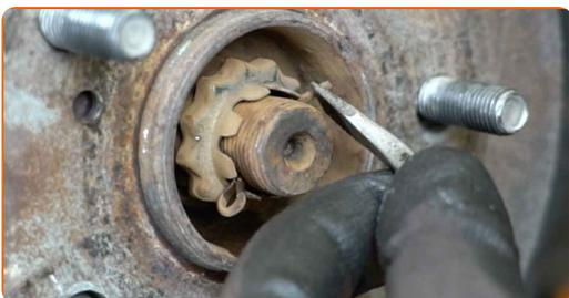
**7** Αφαιρέστε το δακτύλιο συγκράτησης (ασφάλεια) του ρουλεμάν της πλήμνης του τροχού. Χρησιμοποιήστε ένα λοστό.
