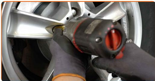
**62** Χαμηλώστε το αυτοκίνητο και χρησιμοποιήστε σταυρό, προκειμένου να σφίξετε τα μπουλόνια των τροχών. Χρησιμοποιήστε κρουστικό καρυδάκι για μπουλονόκλειδο No #19. Χρησιμοποιήστε ένα δυναμόκλειδο. Σφίξτε τη με ροπή 103 Nm.
