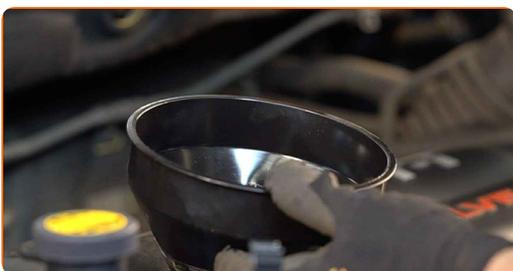
**24** Ρίξτε καινούριο λάδι στον κινητήρα στην ποσότητα που συνιστάται από τον κατασκευαστή του αυτοκινήτου.
