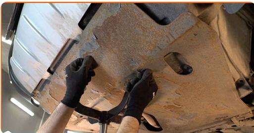
**21** Σφίξτε τα στοιχεία στερέωσης του κάτω καλύμματος του κάρτερ λαδιού. Χρησιμοποιήστε ένα καρυδάκι #12.
