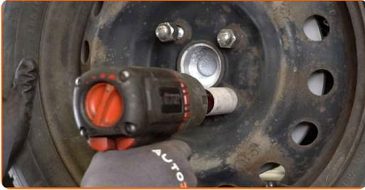
**50** Χαμηλώστε το αυτοκίνητο και χρησιμοποιήστε σταυρό, προκειμένου να σφίξετε τα μπουλόνια των τροχών. Χρησιμοποιήστε κρουστικό καρυδάκι για μπουλονόκλειδο No #21. Χρησιμοποιήστε ένα δυναμόκλειδο. Σφίξτε τη με ροπή 103 Nm.
