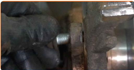
**38** Σφίξτε τα στοιχεία στερέωσης του βραχίονα στήριξης της δαγκάνας φρένων. Χρησιμοποιήστε ένα καρυδάκι #14. Χρησιμοποιήστε ένα δυναμόκλειδο. Σφίξτε τη με ροπή 57 Nm.
