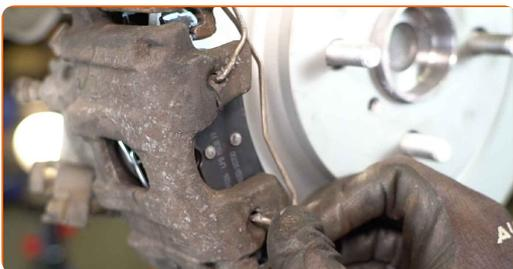
**45** Καθαρίστε το σημείο τοποθέτησης της ζάντας του τροχού. Χρησιμοποιήστε μια συρματοβούρτσα.
