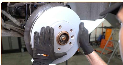
**21** Βιδώστε το στοιχείο στερέωσης του δίσκου φρένων. Χρησιμοποιήστε ένα XZN #10. Χρησιμοποιήστε μια καστίνα.
