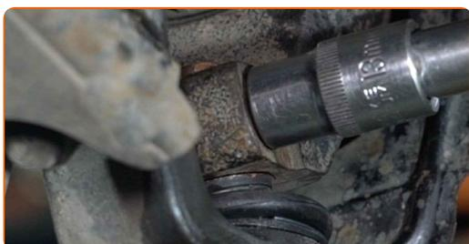
**70** Βιδώστε το στοιχείο στερέωσης που συνδέει το δίχαλο του αμορτισέρ με το μουαγιέ. Χρησιμοποιήστε ένα γερμανοπολύγωνο #18. Χρησιμοποιήστε ένα καρυδάκι #18. Χρησιμοποιήστε μια καστάνια.
