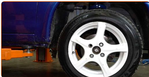
**11** Χαλαρώστε τα στοιχεία στερέωσης του ημιαξονίου. Χρησιμοποιήστε ένα καρυδάκι #30. Χρησιμοποιήστε μια μανέλα κολαούζου.
