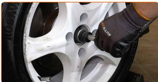
**86** Χαλαρώστε τα στοιχεία στερέωσης του ημιαξονίου. Χρησιμοποιήστε ένα καρυδάκι #30. Χρησιμοποιήστε μια μανέλα κολαούζου.
