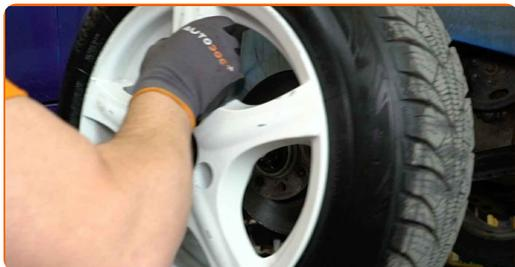
**15** Ξεβιδώστε το στοιχείο στερέωσης που συνδέει τον άξονα κίνησης στην πλήμνη του τροχού. Χρησιμοποιήστε ένα καρυδάκι #30. Χρησιμοποιήστε μια καστάνια.
