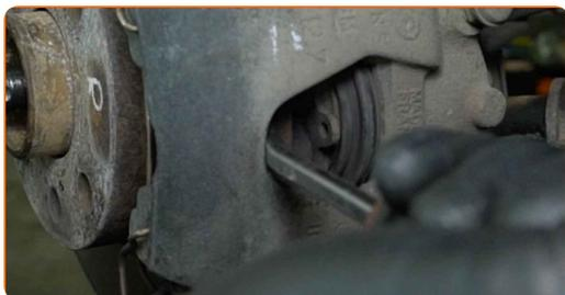
**18** Καθαρίστε τα στοιχεία στερέωσης της βάσης της δαγκάνας των φρένων. Χρησιμοποιήστε μια συρματόβουρτσα. Χρησιμοποιήστε σπρέι WD-40.
