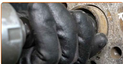
**16** Αφαιρέστε τη ροδέλα ρουλεμάν τροχών. Χρησιμοποιήστε ένα λοστό.
