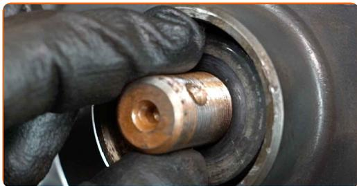
**72** Σφίξτε το παξιμάδι του άξονα κίνησης. Χρησιμοποιήστε ένα καρυδάκι #30. Χρησιμοποιήστε μια καστάνια.
