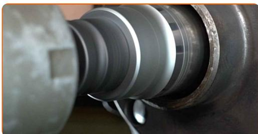
**73** Καθαρίστε την πλήμνη. Χρησιμοποιήστε μια συρματόβουρτσα. Καθαρίστε το σημείο επαφής. Χρησιμοποιήστε κεραμικό γράσο.
