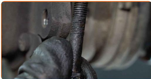
**30** Καθαρίστε το κάτω στοιχείο στερέωσης που συνδέει το γόνατο ανάρτησης με το ακραξόνιο. Χρησιμοποιήστε μια συρματόβουρτσα. Χρησιμοποιήστε σπρέι WD-40.
