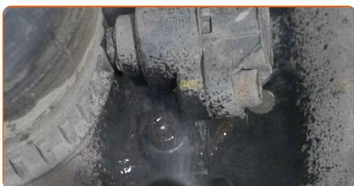
**33** Ξεβιδώστε το μέσο στερέωσης του αισθητήρα ABS. Χρησιμοποιήστε ένα Άλεν Νο.Η5. Χρησιμοποιήστε μια καστάνια.
