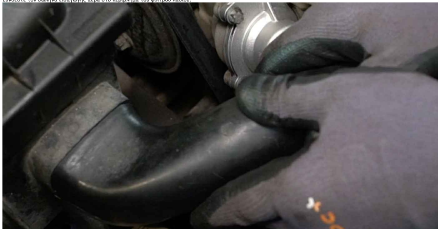
32 Συνδέστε το κλιπ στον σωλήνα εισαγωγής φίλτρου αέρα.
