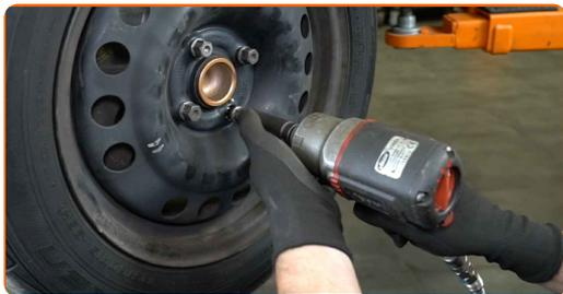
**51** Χαμηλώστε το αυτοκίνητο και χρησιμοποιήστε σταυρό, προκειμένου να σφίξετε τα μπουλόνια των τροχών. Χρησιμοποιήστε κρουστικό καρυδάκι για μπουλονόκλειδο No #17. Χρησιμοποιήστε ένα δυναμόκλειδο. Σφίξτε τη με ροπή 110 Nm.
