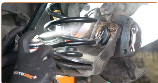
**38** Περάστε από επεξεργασία το τμήμα της πλήμνης του τροχού που έρχεται σε επαφή με το δίσκο του φρένου. Χρησιμοποιήστε γράσο χαλκού.
