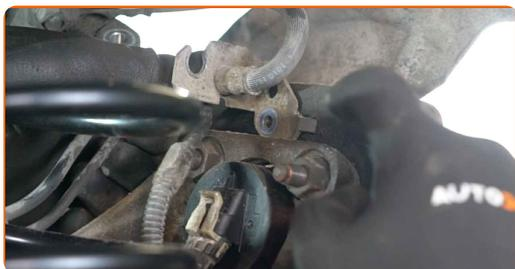
**35** Σφίξτε το στοιχείο στερέωσης του βραχίονα καλωδίωσης του ABS. Χρησιμοποιήστε ένα καρυδάκι #E8. Χρησιμοποιήστε ένα δυναμόκλειδο. Σφίξτε τη με ροπή 7 Nm.
