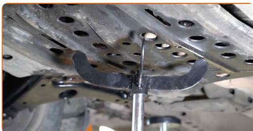
12 Ξεσφίξτε τα στοιχεία στερέωσης του κάτω καλύμματος του κάρτερ λαδιού. Χρησιμοποιήστε ένα καρυδάκι #12.
