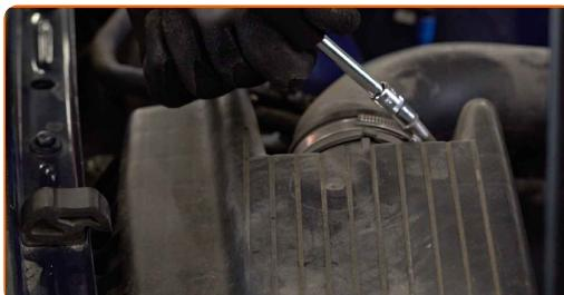
5 Αποσυνδέστε τον σωλήνα εισαγωγής αέρα από το περίβλημα του φίλτρου αέρα.
