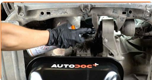
**10** Ξεβιδώστε το φίλτρο λαδιού. Χρησιμοποιήστε ένα καρυδάκι 76-F14. Χρησιμοποιήστε μια καστανία.
