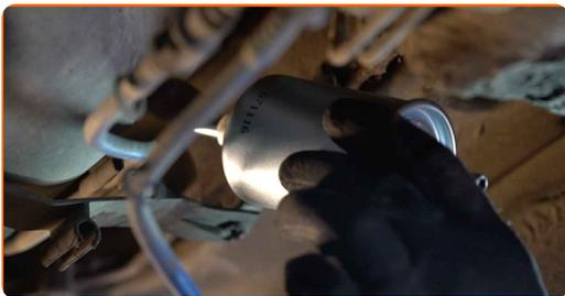
**10** Σφίξτε τα στοιχεία στερέωσης του φίλτρου καυσίμου. Χρησιμοποιήστε ένα Τορξ T20.
