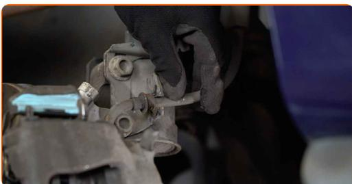
**27** Τοποθετήστε το κλιπ συγκράτησης του μαρκουτσιού των φρένων. Χρησιμοποιήστε ένα λοστό.
