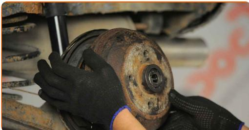
**23** Βιδώστε το στοιχείο στερέωσης του μουαγιέ τροχού. Χρησιμοποιήστε ένα γερμανοπολύγωνο #24.
