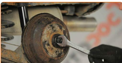
**24** Τοποθετήστε την κοπίλια του παξιμαδιού στερέωσης του ρουλεμάν της πλήμνης. Χρησιμοποιήστε
