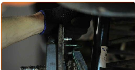
**19** Εξαερώστε το σύστημα του κυλινδρακίου των φρένων. Χρησιμοποιήστε ένα γερμανοπολύγωνο #9.
