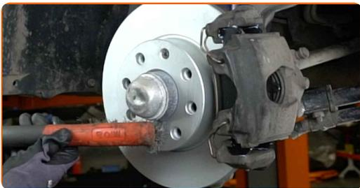
**22** Επεξεργαστείτε την επιφάνεια που ακουμπά ο δίσκος του φρένου στη ζάντα του τροχού. Χρησιμοποιήστε κεραμικό γράσο υψηλής θερμοκρασίας.
