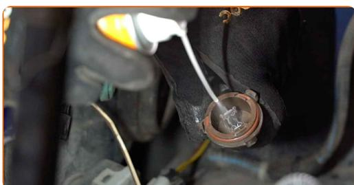
**15** Τοποθετήστε ένα καινούριο λαμπτήρα στο ντουί.
