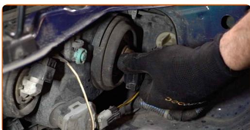
**12** Βγάλτε τον παλιό λαμπτήρα. Χρησιμοποιήστε ένα ίσιο κατσαβίδι.
