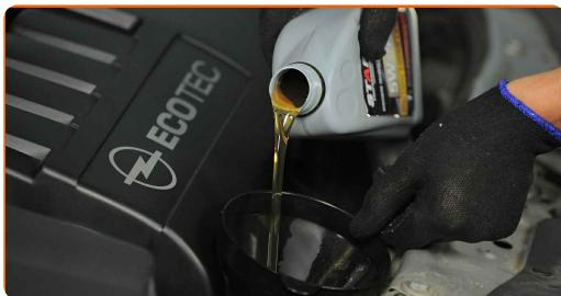
Αντικατάσταση: λαδια και φίλτρα λαδιού - VAUXHALL COMBO Mk II (C)
