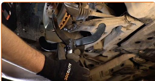
**Αντικατάσταση: γόνατο ανάρτησης - VAUXHALL COMBO Mk II (C)
