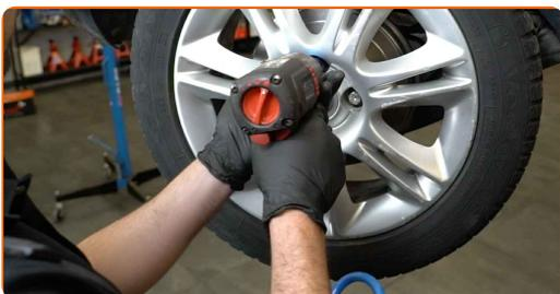
25 Χαμηλώστε το αυτοκίνητο και χρησιμοποιήστε σταυρό, προκειμένου να σφίξετε τα μπουλόνια των τροχών. Χρησιμοποιήστε κρουστικό καρυδάκι για μπουλονόκλειδο Νο #17. Χρησιμοποιήστε ένα δυναμόκλειδο. Σφίξτε τη με ροπή 110 Nm.
