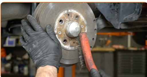
**7** Ξεβιδώστε τα στοιχεία σύσφιξης του ταμπούρου των φρένων. Χρησιμοποιήστε ένα Τορξ T30. Χρησιμοποιήστε μια κασάνια.
