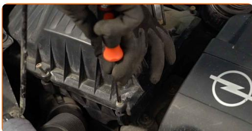
**14** Συνδέστε τον σωλήνα εισαγωγής αέρα στο περίβλημα του φίλτρου λαδιού.
