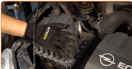
**13** Βιδώστε τις βίδες στερέωσης του καλύμματος του φίλτρου αέρα. Χρησιμοποιήστε ένα σταυροκατσάβιδο.
