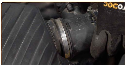
**15** Σφίξτε το κολάρο του σωλήνα εισαγωγής αέρα. Χρησιμοποιήστε ένα καρυδάκι #7. Χρησιμοποιήστε μια καστίνα.
