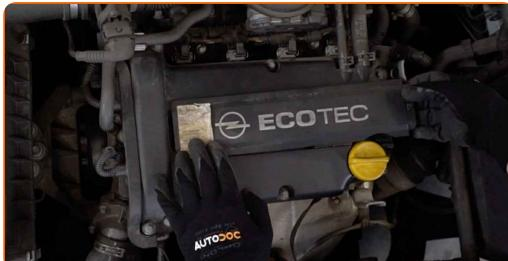
**3** Ξεκουμπώστε τη φίσα από τον πολλαπλασιαστή. Χρησιμοποιήστε ένα ίσιο κατσαβίδι.
