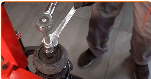
Αντικατάσταση: ελατήρια ανάρτησης - VAUXHALL Corsa Mk II (C) Hatchback (X01). Συμβουλή από το AUTODOC:
