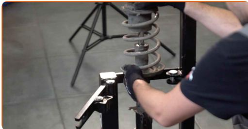
**Αντικατάσταση: ελατήρια ανάρτησης - VAUXHALL Corsa Mk II (C) Hatchback (X01). Οι επαγγελματίες συνιστούν:**
