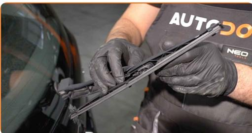
Αντικατάσταση: μάκτρο καθαριστήρα - VAUXHALL Corsa Mk5 (F).
