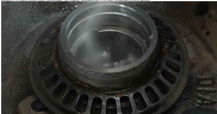
18 Αφαίρεστε τον εξωτερικό δακτύλιο του ρουλεμάν τροχού στο ταμπόρο φρένων. Σετ εξωκένων ανιμπλόκ και ρουλεμάν.
