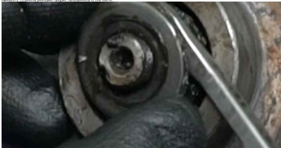
10 Αφαιρέστε το ρουλεμάν μοχλιέ τροχού. Χρησιμοποιήστε ένα λοστό.
