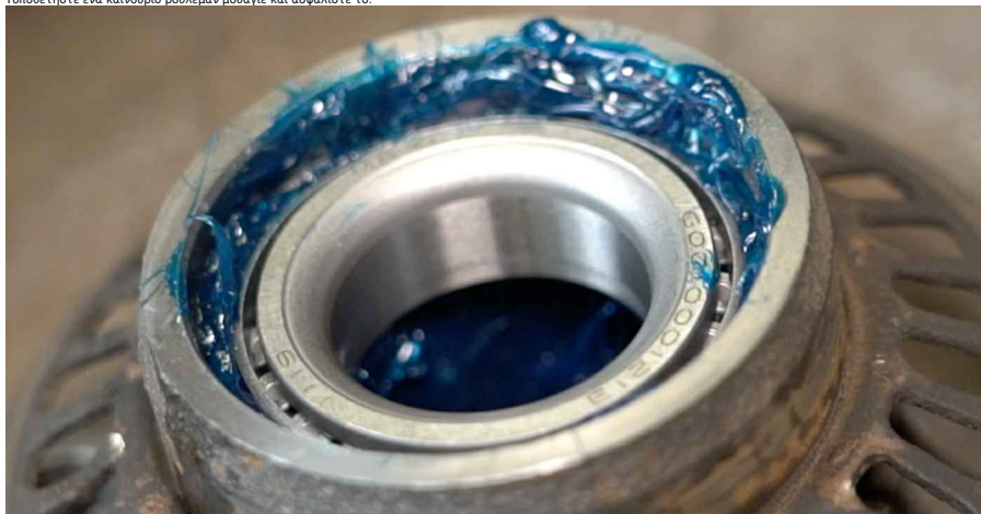
22 Τοποθετήστε τη ταινία λαδιού του ρουλεμάν τροχών.
