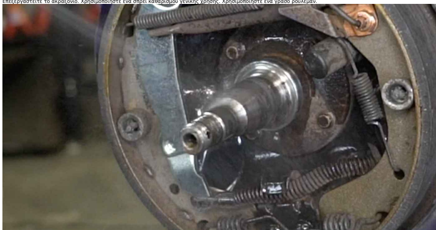
24 Τοποθετήστε το ταμπούρα φρένων που έχει συναρμολογηθεί με το ροτλεμέν μοσάνι τροχού.
