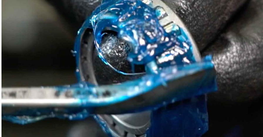
21 Τοποθετήστε ένα καινούριο ρουλεμάν μοσάνι και ασφαλίστε το.
