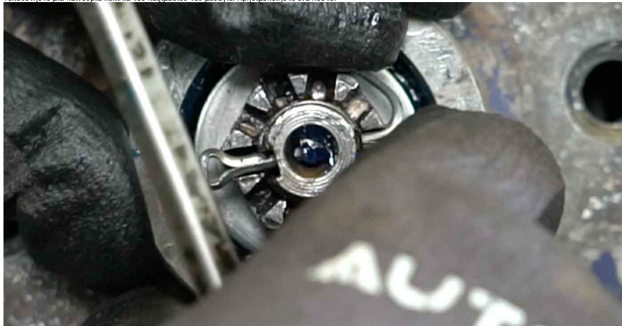
34 Τοποθετήστε το καπάκι της πλήμνης. Χρησιμοποιήστε μια λαστιχένια ματσόλα.
