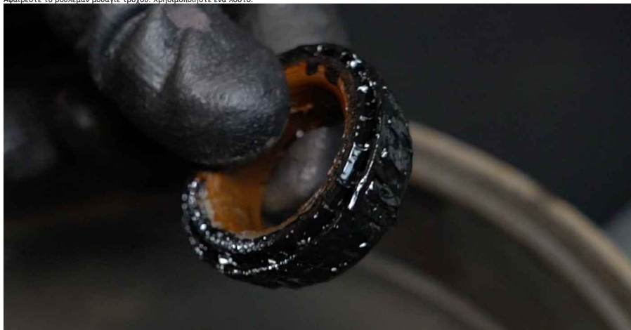
14 Καθαρίστε το σημείο τοποθέτησης του ρουλεμάν της πλήμνης.
