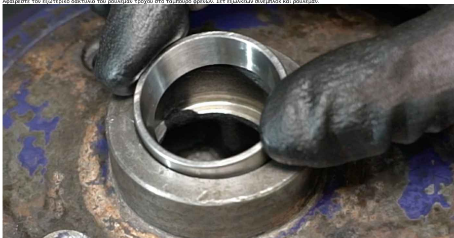
19 Τοποθετήστε τον καινούριο εσωτερικό δακτύλιο του ρουλεμάν τροχού στο ταμπόρο φρένων. Σετ εξωκένων ανιμπλόκ και ρουλεμάν.
