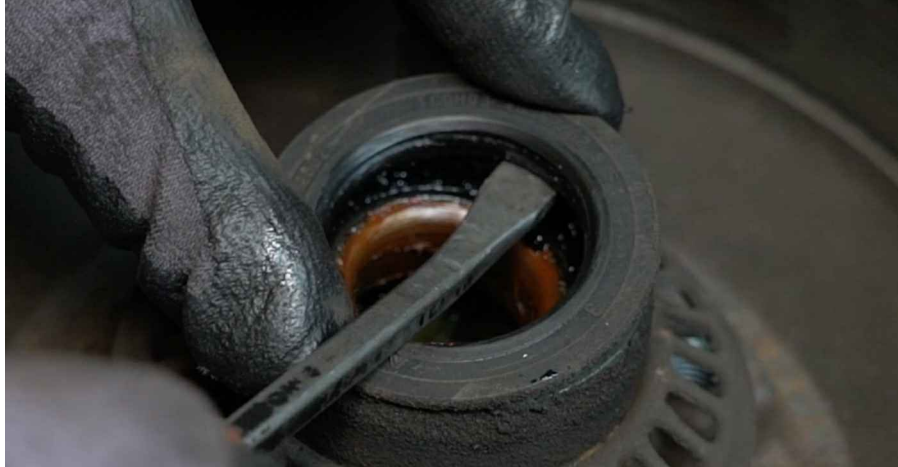
13 Αφαιρέστε το ρουλεμάν του αριστερού τροχού. Χρησιμοποιήστε ένα λαστιό.
