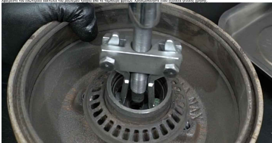
15 Αφαιρέστε τον εσωτερικό δακτύλιο του ρουλεμάν τροχού από το ταμπόρο φρένων. Χρησιμοποιήστε έναν εξολκέα γενικής χρήσης.
