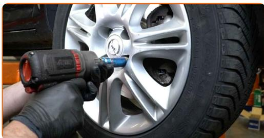
**24** Χαμηλώστε το αυτοκίνητο και χρησιμοποιήστε σταυρό, προκειμένου να σφίξετε τα μπουλόνια των τροχών. Χρησιμοποιήστε κρουστικό καρυδάκι για μπουλονόκλειδο Νο #17. Χρησιμοποιήστε ένα δυναμόκλειδο. Σφίξτε τη με ροπή 110 Nm.
