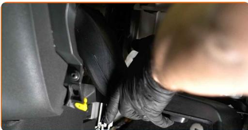
**17** Τοποθετήστε τα στοιχεία στερέωσης του περιβλήματος της εισαγωγής αέρα.
